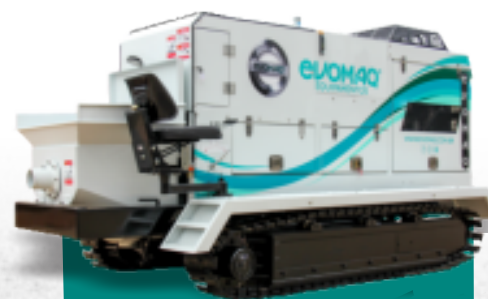
BOMBA DE CONCRETO SOBRE ESTEIRA EVOMAQ®
