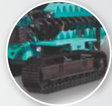
As esteiras da Hélice Contínua EVOMAQ® foram projetadas para terrenos complexos, facilitando sua mobilidade na obra.
